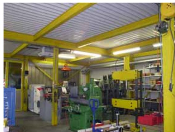
Bild 79: Typischer Fabrikationsraum: Stahlbau mit Profilblech, ohne wirksame Akustikdecke. Dieser Raum wirkt sehr hallig, und der Maschinenlärm stört stark im ganzen Raum.
