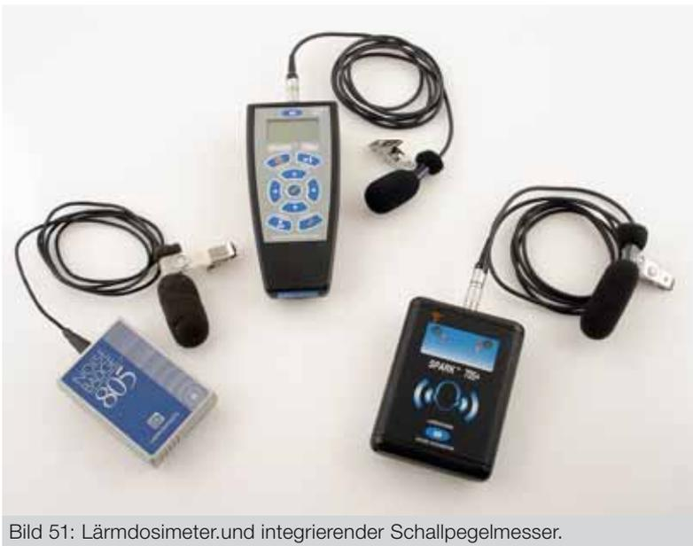
Bild 51: Lärmdosimeter und integrierender Schallpegelmesser.
