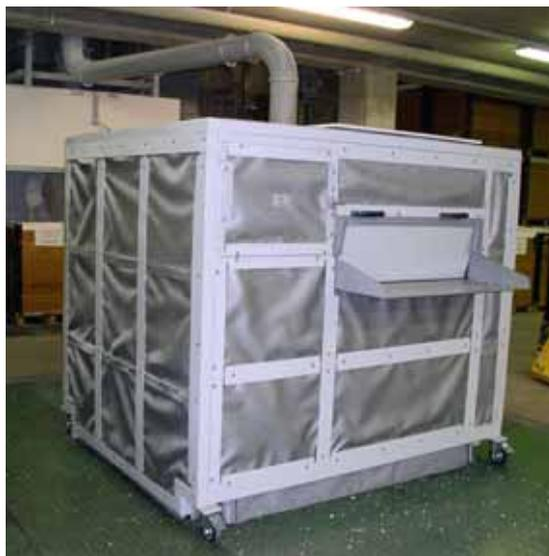
Bild 71: Kapselung einer Mühle für Kunststoffabfälle. Erzielte Pegelsenkung: zirka 12 dB(A).
