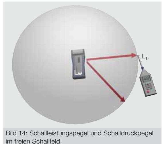
Bild 14: Schalleistungspegel und Schalldruckpegel im freien Schallfeld.
