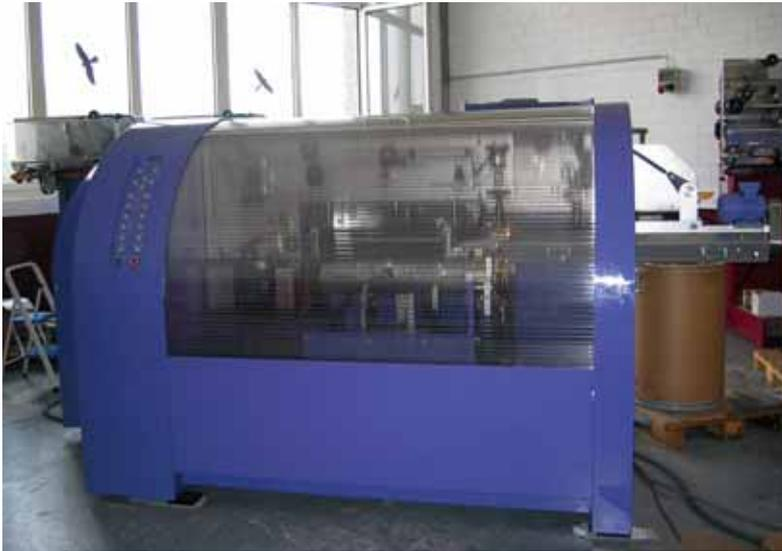
Bild 72: Kapselung eines Dosenschweissautomaten. Durch die Kapselung wird der Schallpegel auf der Aussenseite auf 82 dB(A) reduziert.
