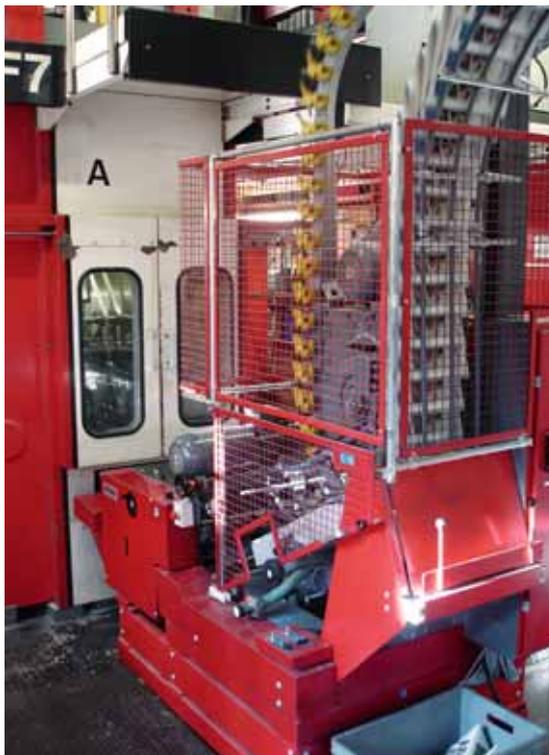
Bild 73: Gekapselter Falzapparat (Hintergrund) und Auslage einer Zeitungsdruckmaschine. Der Schallpegel wird von 98 auf 84 dB(A) gesenkt.
