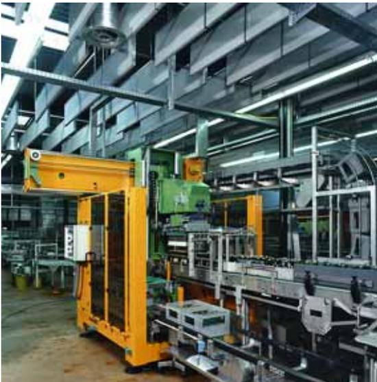
Bild 81: Akustikdecke in einer Flaschenabfüllerei. Hier werden Mineralfaserdämmplatten als sogenannte «Baffeln» eingesetzt.
