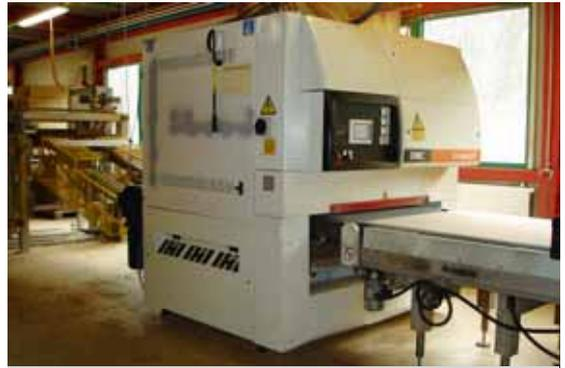
Bild 74: Gekapselte Flachsleifmaschine zur Herstellung von Bodenbelägen.
