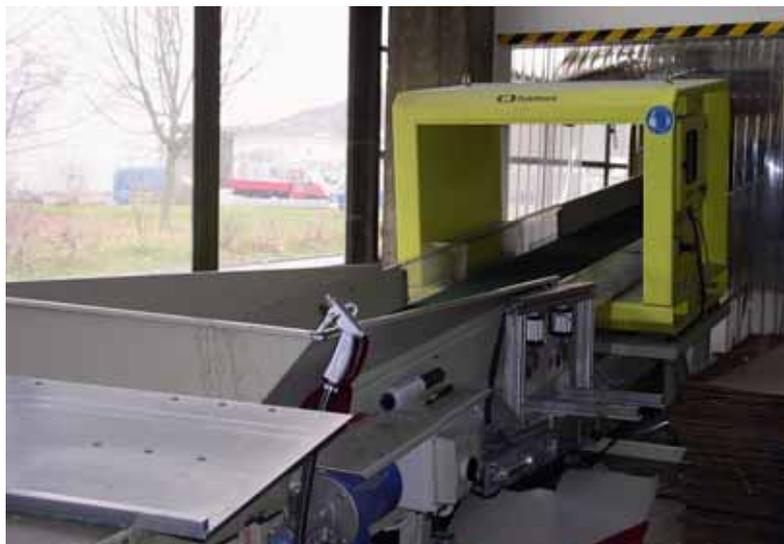
Bild 76: Transportband einer Kunststoffmühle.
