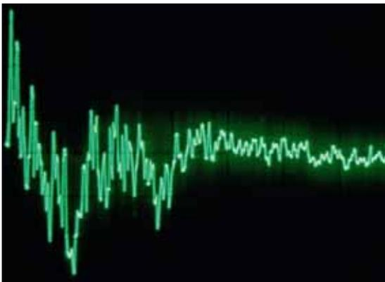
Bild 25: Knall bei der Airbag-Auslösung, Spitzenpegel  $L_{\text{peak}} = 160 \text{ dB(C)}$ .
