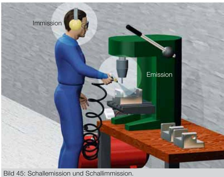
Bild 45: Schallemission und Schallimmission.
