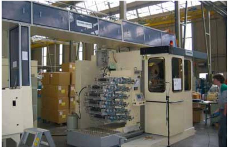
Bild 70: Teilkapselung an einer Tubendruckmaschine (200 Tuben/min); in 1 m Abstand wird noch ein Schallpegel von 77 dB(A) gemessen.
